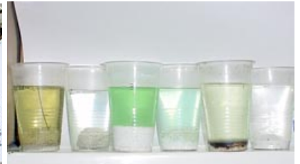
③固まったろ材を薬品で洗浄分解する テストをしました。
